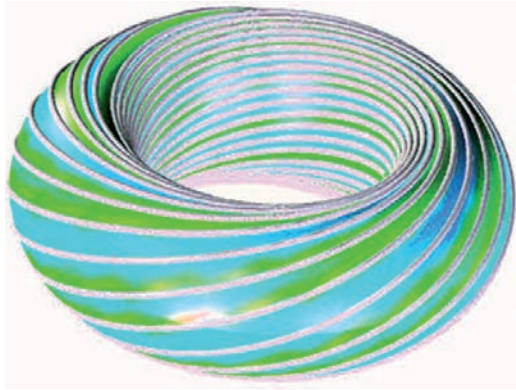
Obr. 11. Grafické znázornění šroubovitých (helikálních) magnetických siločar v tokamaku
