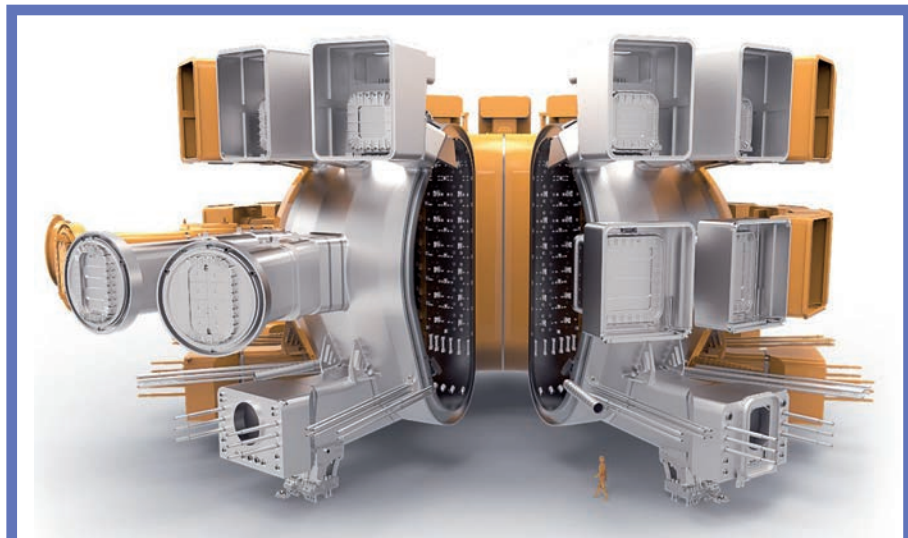
Obr. 16. Model vakuové nádoby ITER. Nádoba je dvouplášťová a je chlazená nebo ohřívána vodou s cílem udržení konstantní pracovní teploty. Pracovní teplota nádoby bude při experimentech 100 \text{ }^\circ\text{C} . Při vypékání (odplyňování) bude nádoba krátkodobě zahřátá na 200 \text{ }^\circ\text{C} [1]
